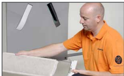
Verwijderen filterdoek van houder
